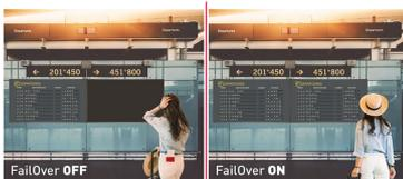
FailOver es una función que detecta automáticamente las fuentes de entrada. Cuando no hay señal en la entrada predeterminada, cambiará automáticamente a la siguiente entrada disponible. FailOver permite a los clientes priorizar una serie de entradas (incluido navegador, reproductor multimedia y personalizado) y garantiza que su contenido siempre se muestre de forma activa.
